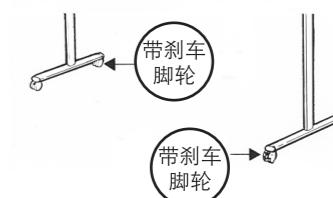
③ 组装时应注意，左右脚部各有一个带刹车的脚轮，其位置应该一前一后错开安装。
