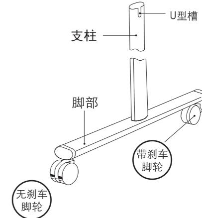
② 将支柱上部有U型槽的一侧朝内，将内六角螺丝从支柱外侧螺丝孔穿过支柱，锁入横杆（共四个螺丝），固定住横杆与支柱。之后用橡胶塞塞住支柱外侧螺丝孔。另一边的支柱照同样方法组装。
