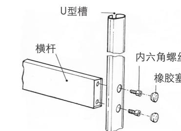
※ 横杆两端有开小孔的一面，安装受粉托架时，请将此孔安排在背面。
